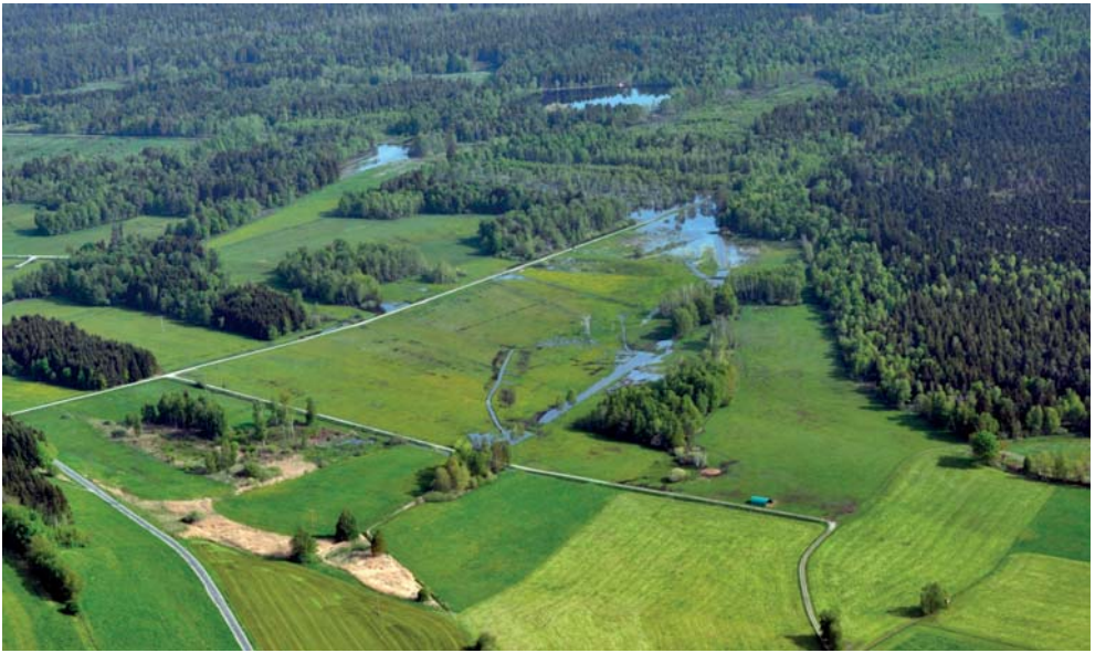
Abb. 8: Blick in randliche Teile des Planungsgebietes 3 Monate nach Wiedervernässung – offene Wasserflächen kennzeichnen eingestaute Sackungsmulden und Torfstiche Aerial photograph of the project area 3 months after rewetting – open water characterises the dammed water in slump hollows and former peat extraction sites
